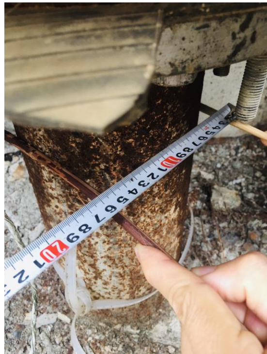
Hình 15. Đo kiểm tra đường kính của 01 ống xả DCTT tại hiện trường (giá trị đường kính 160mm)
