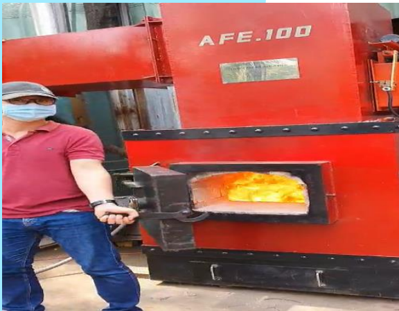
Hình ảnh vận hành đốt rác nguy hại trong Lò hồ quang
