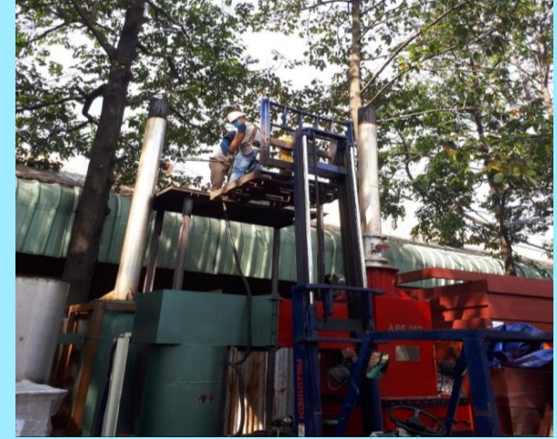
Đưa thiết bị lên vị trí lấy mẫu khí thải trên ống khói
